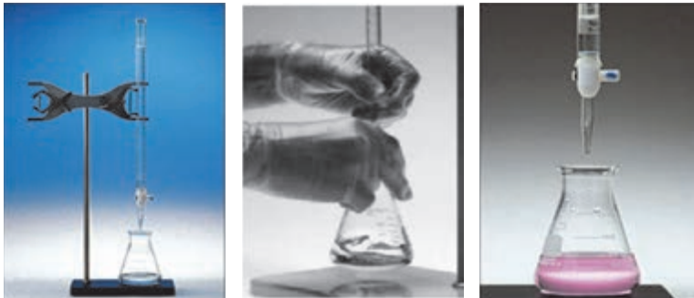
شکل ۱۱- طرح ساده‌ای از آزمایش سنجش حجمی
