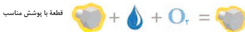
شکل ۱- قطعه فلزی حفاظت نشده و قطعه حفاظت شده در برابر عوامل خوردنده موجود در هوا (رطوبت و اکسیژن)
