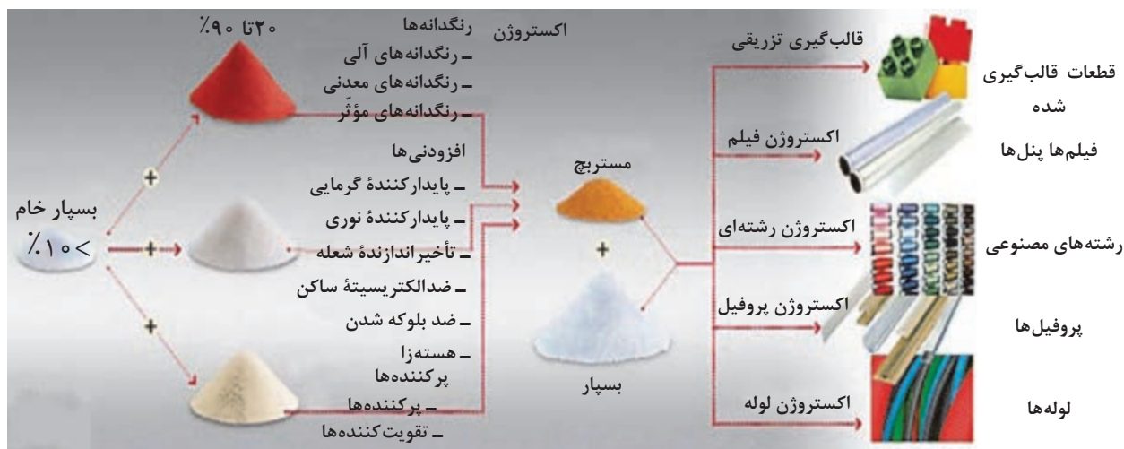
شکل ۶- فرایند تولید مستر بیج و قطعات بسیاری
