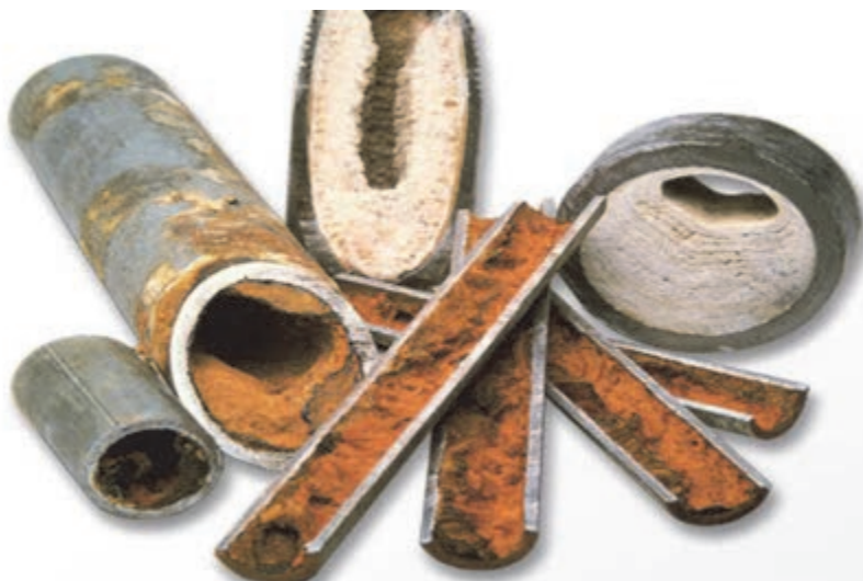
شکل ۴- خوردگی و رسوبات تشکیل شده در لوله‌های دیگ بخار
